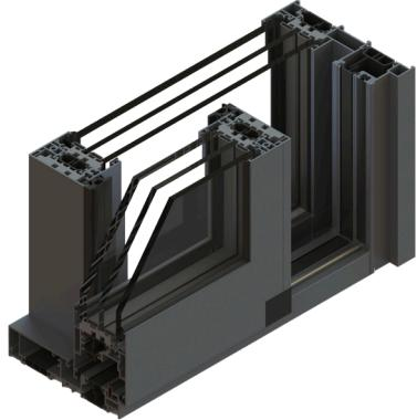
DAS145 è il primo sistema alzante scorrevole della nuova famiglia DOGMA con profili ridotti. I "numeri" che lo caratterizzano sono: telaio da 145mm anta da 65mm portata da 250 Kg fino a 400 Kg Uf del nodo base inferiore a 1,5W/mqK. DOGMA DAS145 consente di realizzare le principali tipologie 2 o più ante con o senza fissi laterali. Ferramenta di chiusura tradizionale con riscontri sul telaio o a ganci. DOGMA DAS145, il ritratto dell'eleganza.
